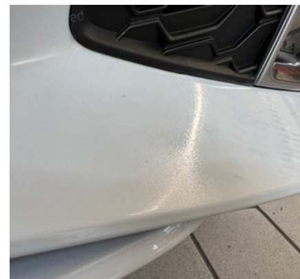
Riparazione della verniciatura scadente (spot repair)
