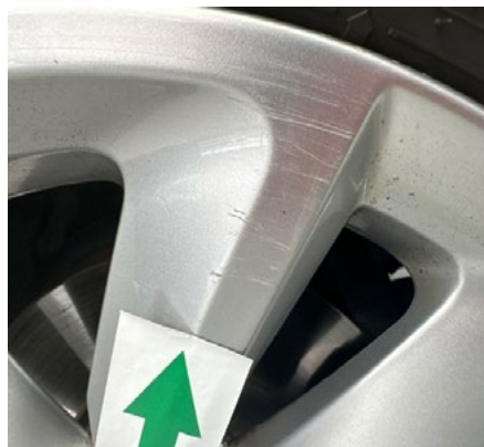
Graffi leggeri senza rimozione di materiale
