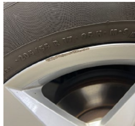
Danno al bordo del cerchio con rimozione di materiale
