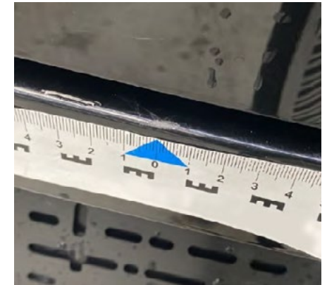
Éraflure dans la zone de chargement
