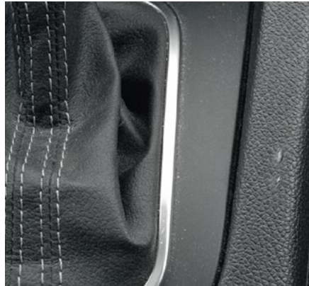
Endommagement léger du revêtement en plastique
