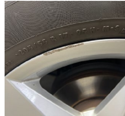
Rebord de jante endommagé avec abrasion du matériau
