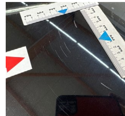
Peinture de base endommagée
