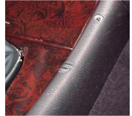
Déformation des garnitures en plastique
