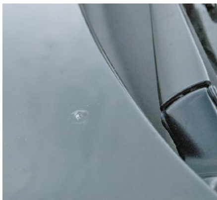
Moins de trois enfoncements par véhicule
