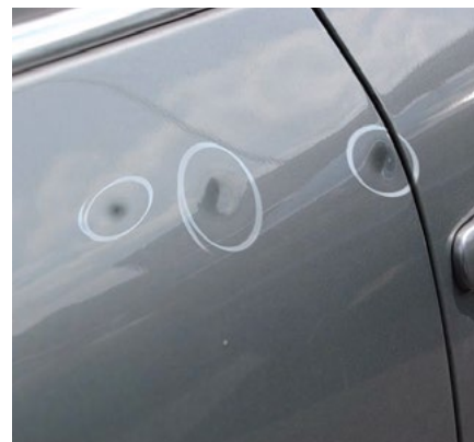
Plus de trois enfoncements par véhicule
