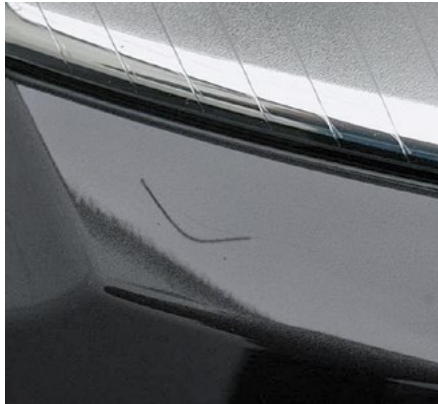
Rayures à la surface de la peinture &lt; 100 mm
