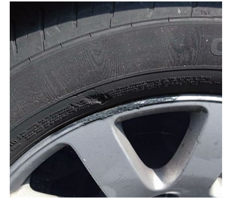
Flancs des pneus endommagés
