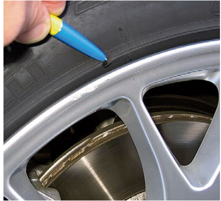
Scheuerleiste leicht eingeschnitten
