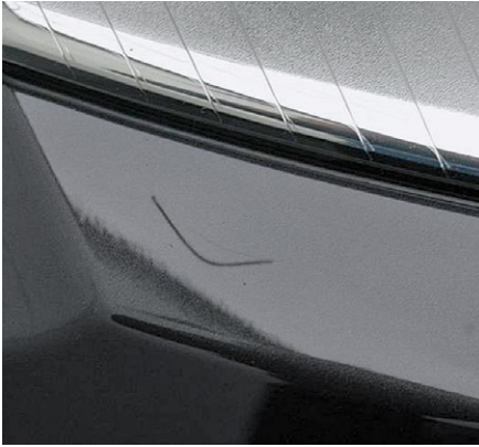
Kratzer in der Lackoberfläche < 100 mm
