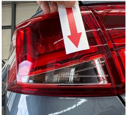
Riss/tiefe Kratzer in Scheinwerfer/Rückleuchte
