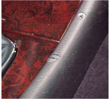
Verformung in der Kunststoffverkleidung
