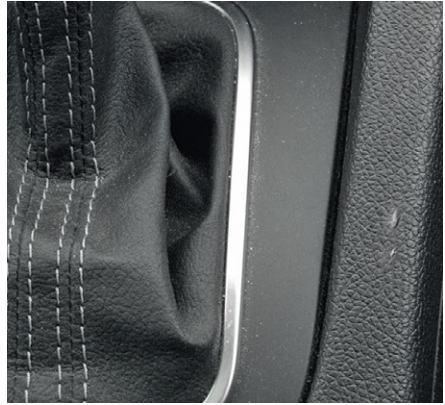
Geringfügige Beschädigung der Kunststoffverkleidung
